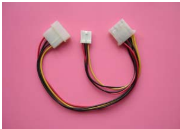
1. rozdvojka napájení, OM se napájí pouze 5V
