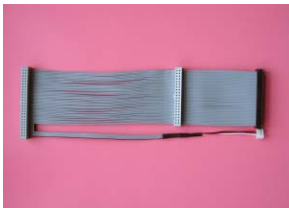
2. datový kabel s audio konektorem, odříznuté žíly z plochého kabelu jsou v původním zapojení využity k napájení 5V
