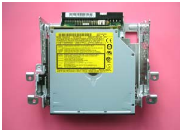
17. nakonec celé vložil do kompletního držáku a připevnil redukci slimATAPI/IDC40 (IDE 40)
