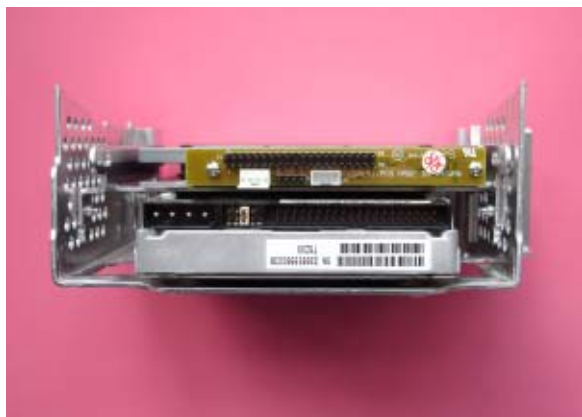
19. pohled ze strany datových konektorů, HD má zatím jumper na pozici Master, ale je dobře patrné jeho otočení o 180°
