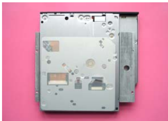
11. OM s připevněnou mechanickou redukcí zajišťující její správnou polohu
